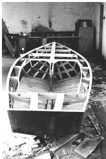
Båten har vänts på rätt köl. Bordläggningen sitter där. Det är bara däck som skall på.
